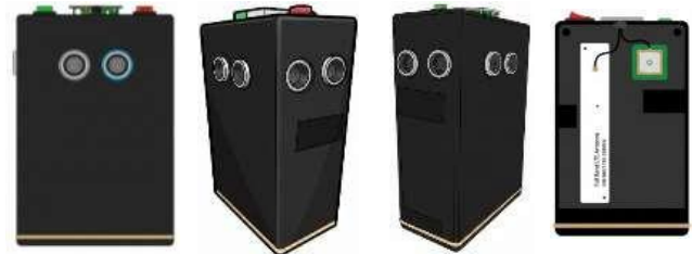
Gambar 6 menampilkan desain fisik tongkat pintar dari berbagai sudut pandang: tampak depan (sensor HC-SR04 depan), tampak kiri dan kanan (sensor HC-SR04 kiri dan kanan), tampak belakang (antena 4G LTE dan antenna GPS), serta tampak atas (speaker, switch on/off, dan tombol darurat SOS).
